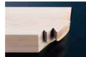
斜め梁端部 アリ大入れ掛け加工
